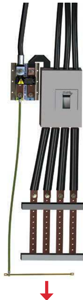
Esquema TN-S alimentación directa de potencia
